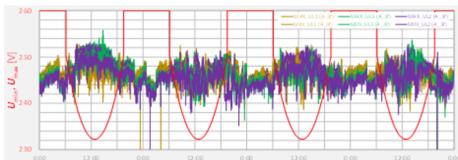
Rys. 5. Przebiegi czasowe maksymalnych i minimalnych wartości skutecznych U napięć fazowych i aproksymacji mocy (linia czerwona) w złączu zasilającym posesję z instalacją fotowoltaiczną A w dn. 3-6.06
